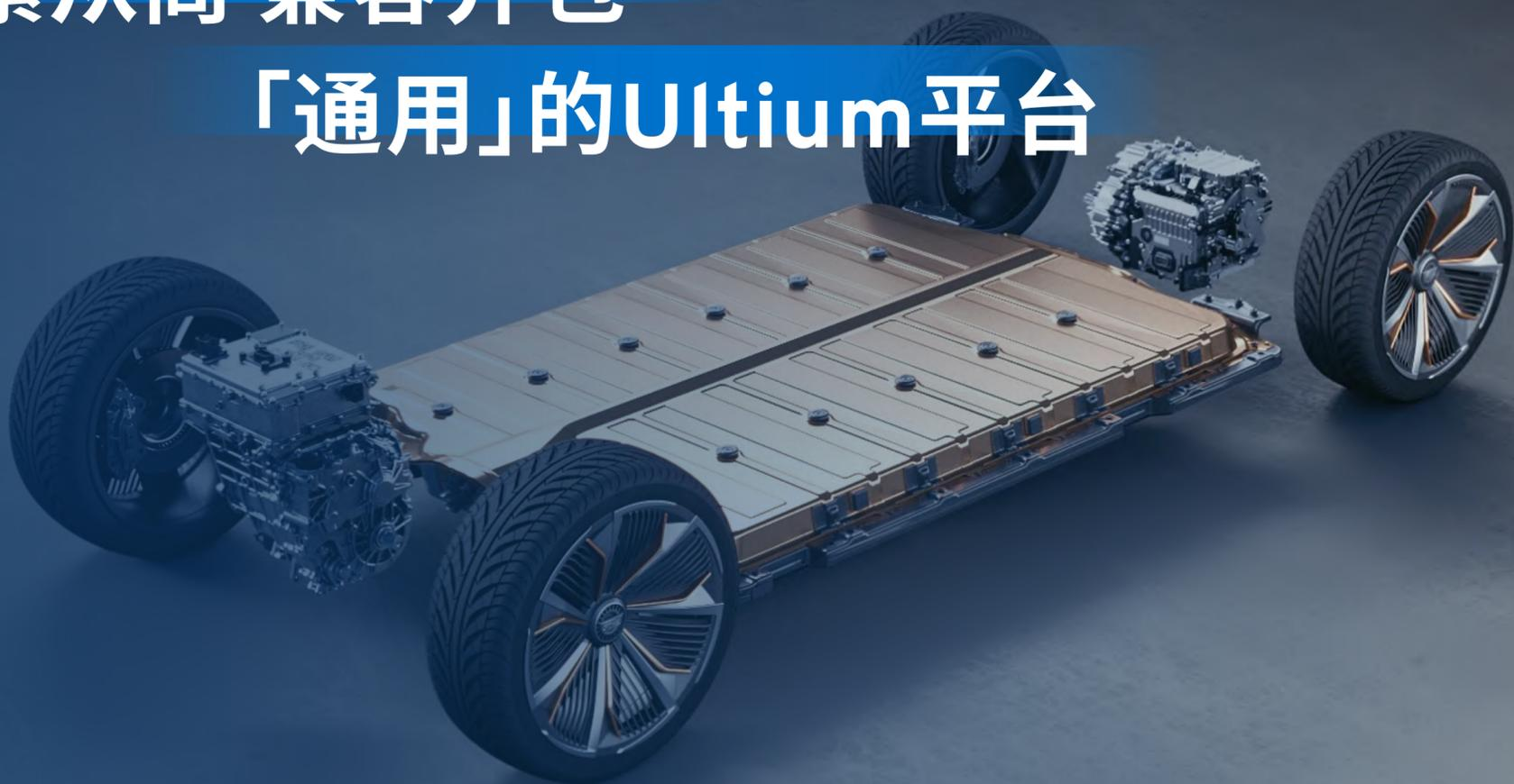
Ultium平台是通用汽车全面电气化的基石。该平台垂直整合了公司电气化技术优势,以电池和电机的模块化设计为核心,并采用业内首创的无线电池管理系统,将凭借规模效应和技术创新,不断提升电动车的经济性。
